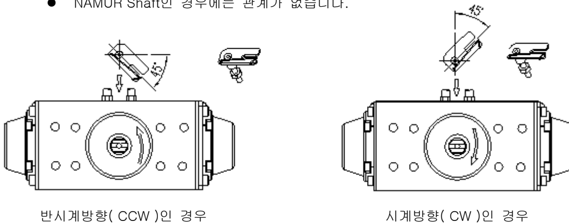
그림 : 포크레버의 설치 위치
