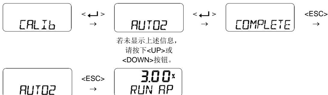
※ 自动校准2完成后重置的参数
