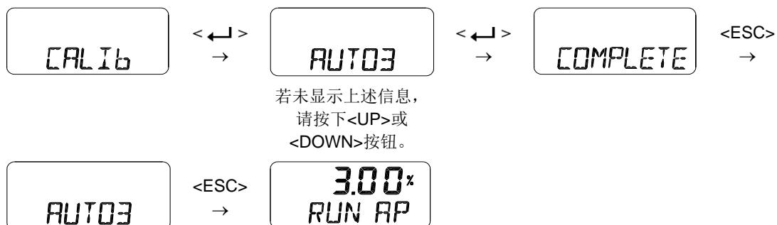
※ 自动校准3完成后重置的参数
