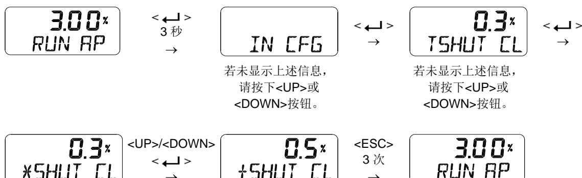
下图显示了当将对应于紧密打开或紧密关闭的输入信号施加到设备时阀门行程的操作。
