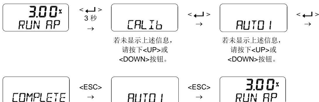
※ 自动校准1完成后重置的参数
