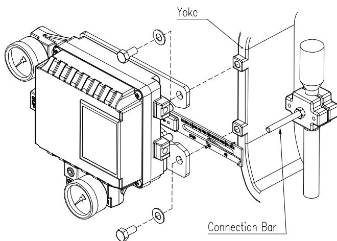
图4-4: 将支架安装于执行器轭上
