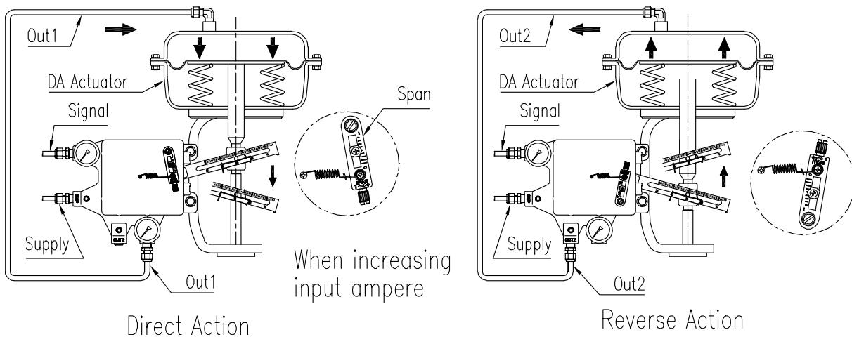
图5-3：设置直行程DA单作用执行器的管路和跨度件方向
