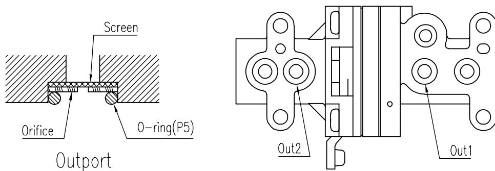
图6-11：安装孔口件
