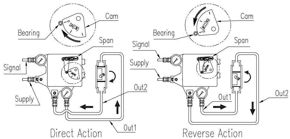
图5-9：设置角行程双作用执行器的管路和凸轮的方向
