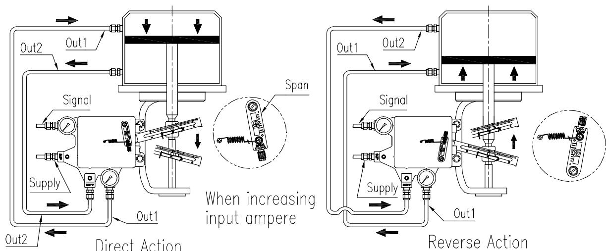
图5-8: 设置直行程双作用执行器的管路和凸轮的方向
