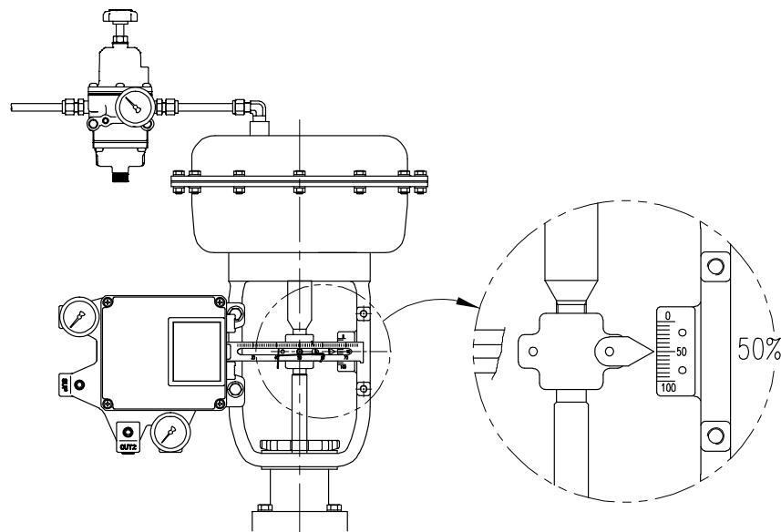
图4-5：将阀门置于总行程50 %的位置
