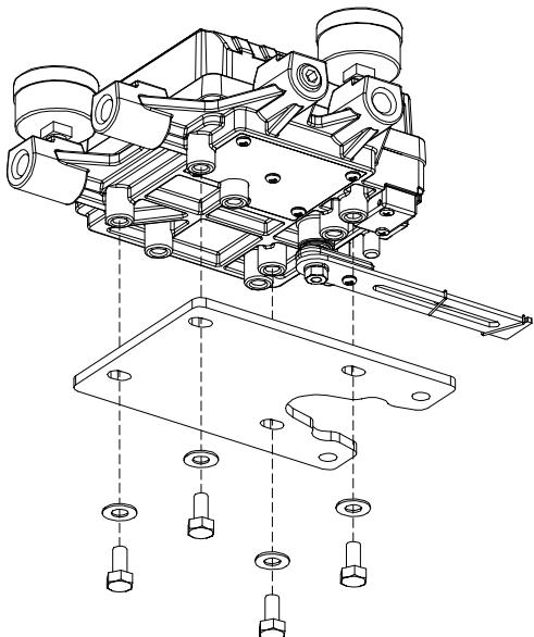
图4-3: 将定位器安装于支架上
