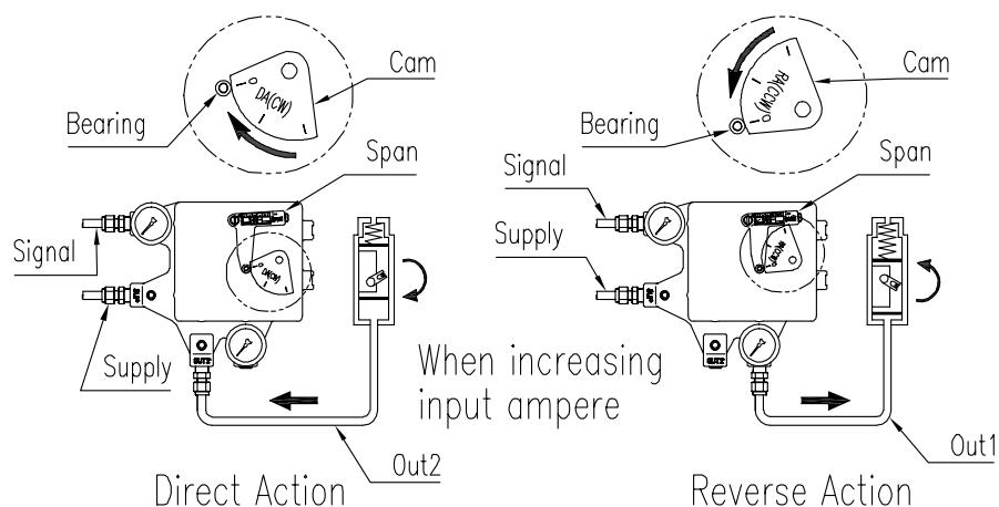
图5-5：设置角行程单作用执行器的管路和凸轮的方向
