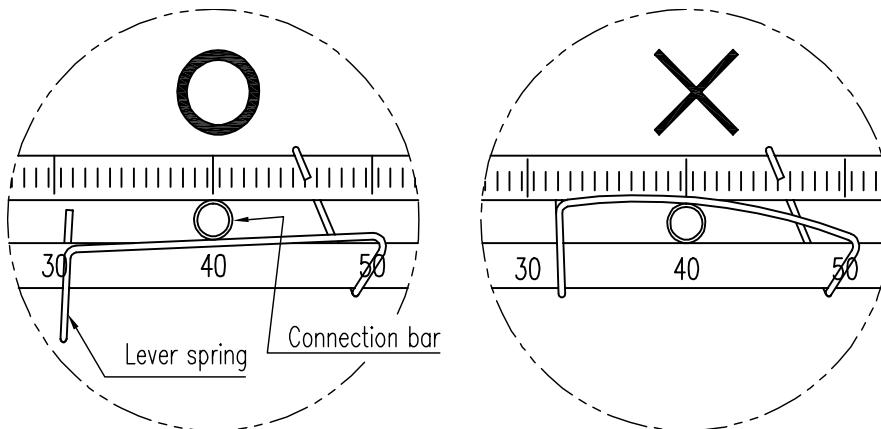
图4-6：将连接杆插入反馈杆和反馈杆弹簧之间的正确方式
