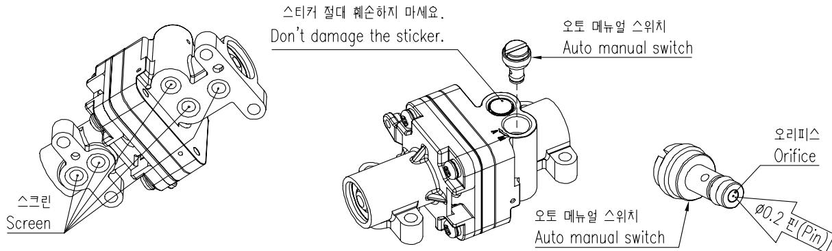
图7-1：引导装置和自动/手动开关
