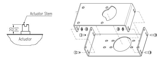
Fig. 4-13: Actuator stem Height
